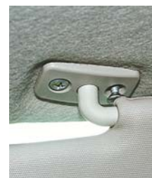
Один из саморезов кронштейна солнцезащитного козырька раскручивался дважды.
