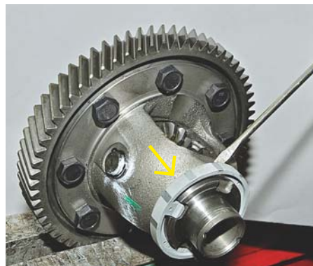
Коробка дифференциала Приоры с задающим кольцом датчика скорости.
