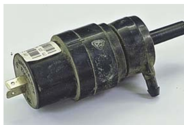
К 25 000 км «кончился» насос омывателя заднего стекла. К счастью, моторчик стоит 220 рублей и найти его можно в любом магазине запчастей.
